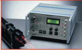
10 mW HeNe-Laser, Schnittweite der Sonde  $f = 90-160$  mm, ungeschiftet, Avalanche-Photodiode, Geschwindigkeitsbereich  $v < 40$  m/s Anwendungsbereich: z.B. Kalibrierung von Strömungssensoren
