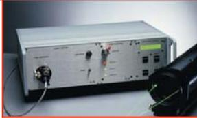
150 mW Nd:YAG-Laser integriert im Controller, auch mit Argon-Ionen-Laser verfügbar, eine Sendefaser (monomode, polarisationserhaltend), Braggzelle und Photomultiplier in der Sonde fp80 integriert, Schnittweite  $f = 310-500$  mm, Geschwindigkeitsbereich  $v < 100$  m/s
