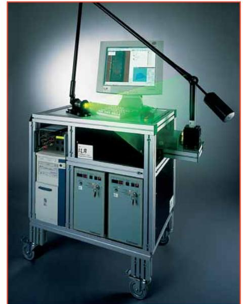
Laser: Nd:YAG von 25 bis 120 mJ/Puls Lichtarm: Arbeitsbereich 1600 mm, sieben frei bewegliche Elemente, Carbonfaser Konstruktion, antireflexbeschichtete Spiegel Lichtschnittoptik: Variabler Lichtschnittwinkel zwischen 10-20°, parallel 50 mm oder 100 mm, endoskopische Optik auf Anfrage Korrelationskamera: Peltier gekühlt, 1280x1024 Pixel, minimaler Frameabstand 200 ns, 12 Bit Grauwerte, sehr hohe Quanteneffizienz Software: VidPIV NT/2000, Stereo, LIF und Multiprozessor-Unterstützung
