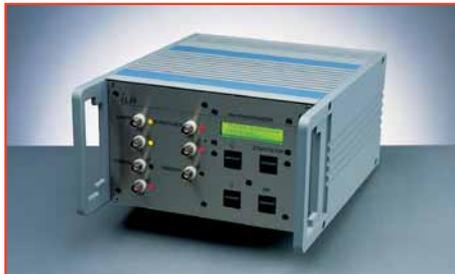
Externer PIV Synchronizer mit LC-Display und Fronttastatur, kürzester Pulsabstand 125 ns, Ausgänge für Laser- und Kamerasteuerung, externer Triggereingang für phasen-synchrone Bildaufnahme
